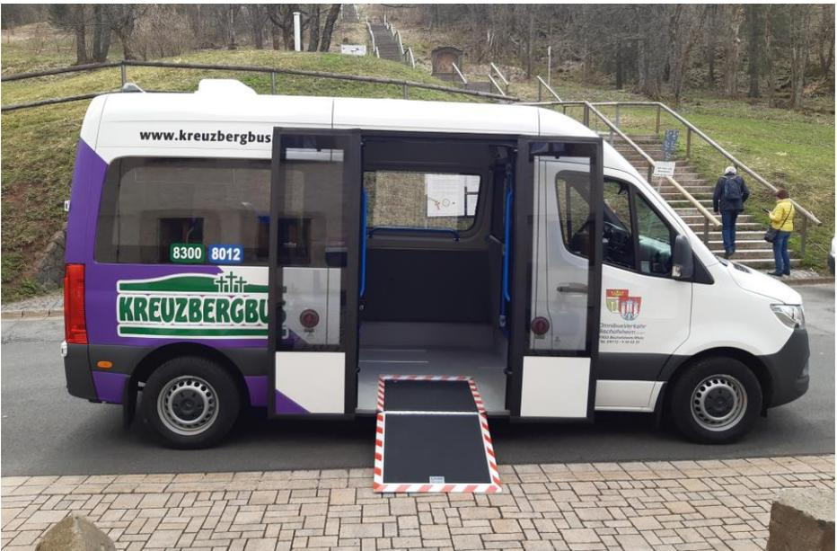
**Bildunterschrift:** Der neue Kreuzbergbus mit Klapp-Rampe zur Beförderung von Personen mit Rollstühlen
